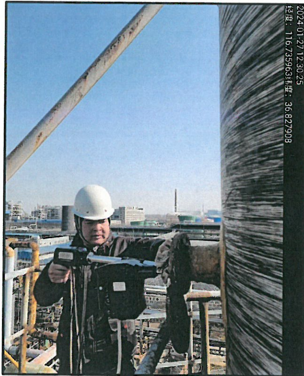
附图：对甲酚硫酸（DA040）处理设施后废气采样
